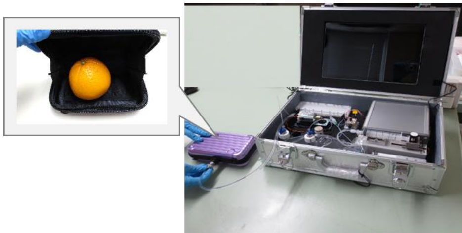
図 匂いセンサモジュールを用いた検疫検査対象物の測定例
